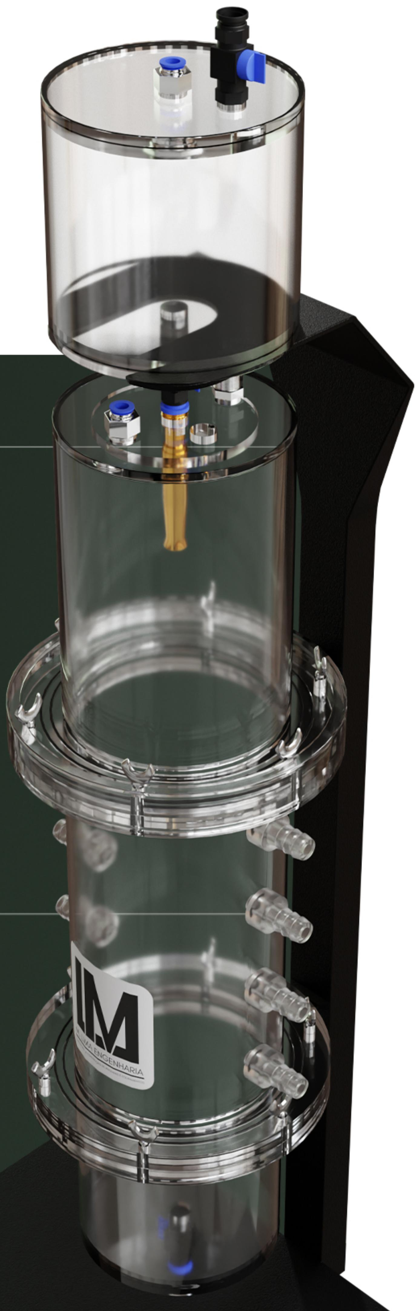
Esse reator é composto por dois compartimentos, um leito maior que fica na parte de baixo, chamado de leito reacional, e outro leito menor que fica na parte de cima. O leito da parte inferior foi feito para ser colocado o inóculo e o substrato sólido, onde de fato ocorre a reação da digestão anaeróbia e o leito superior é para ser colocado o substrato líquido, que é pulverizado no leito reacional onde ocorrerá a biodigestão.
