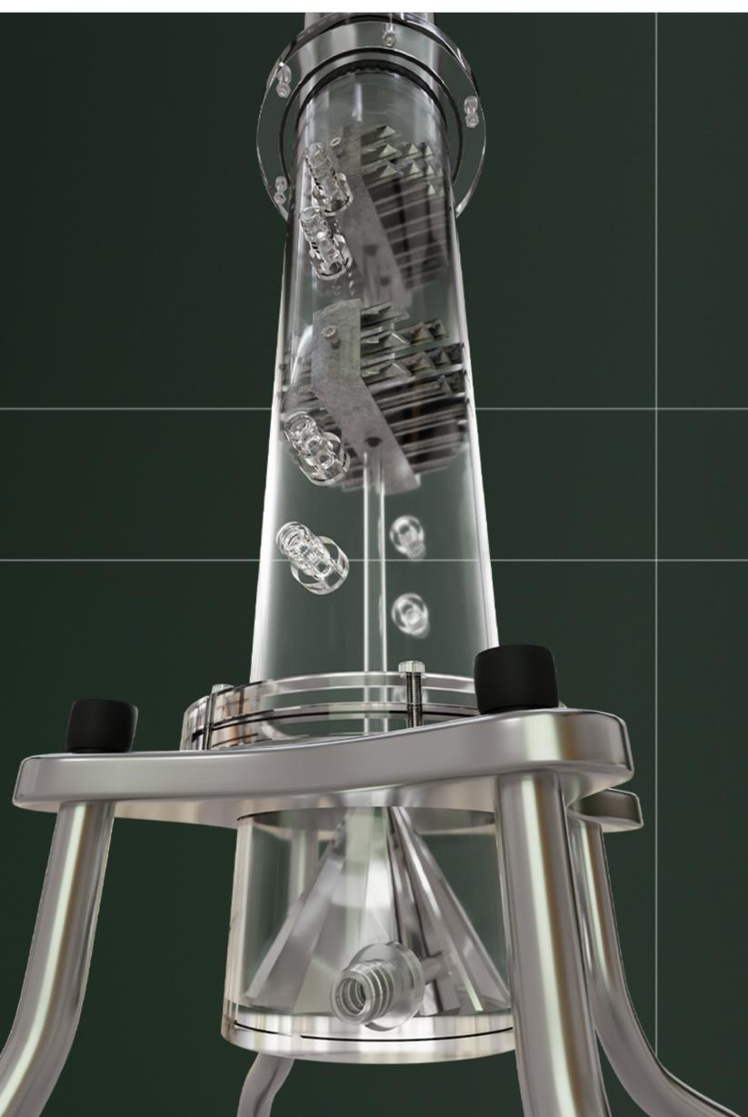
Esse reator possui um fluxo ascendente do efluente que passa pela camada de inóculo onde acontece a biodigestão. Na metade e no topo do reator existem camadas de pequenos separadores trifásicos que fazem com que o efluente volte para o fundo do reator, permitindo somente a passagem do biogás formado.
